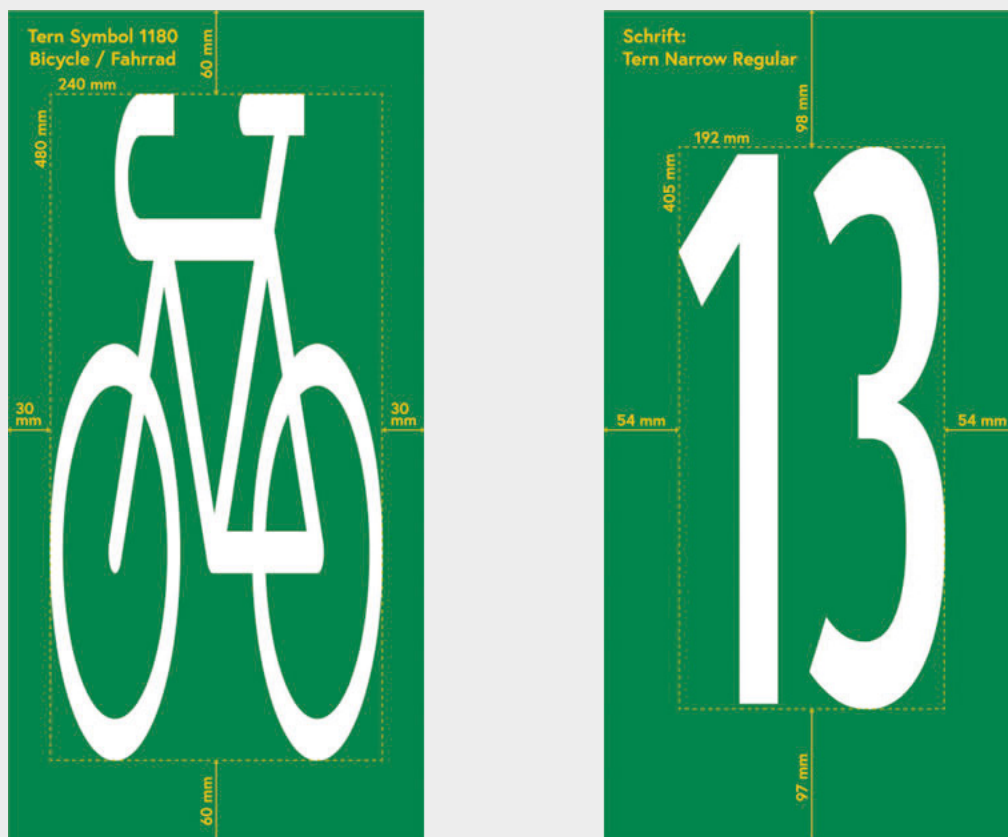
Form und Abmessungen der Elemente einer Bodenmarkierung zur Wegweisung Quelle: RVS 03.02.13 Radverkehr, Seite 77
