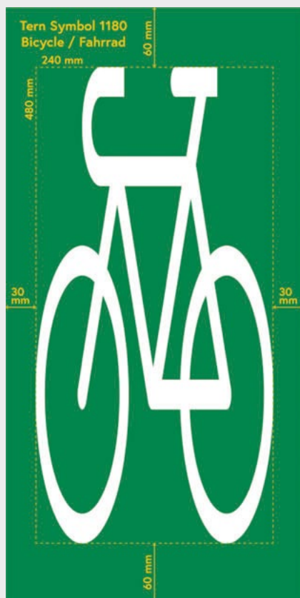
Form und Abmessungen der Elemente einer Bodenmarkierung zur Wegweisung Quelle: RVS 03.02.13 Radverkehr, Seite 77
